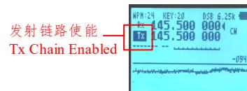
发射链路使能的情况下，将 **5 NOAA** 键作为电键进行CW拍发
