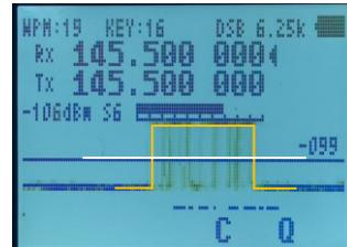
固件根据记录中最长的一条有效信号判断码率，发报方手法不佳可能会造成解码错误
