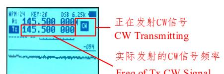
发射时将播放600Hz的侧音作为提示
