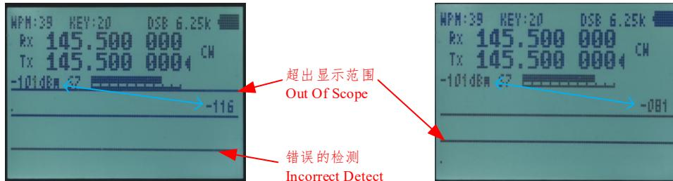
将检测线横穿CW对应的RSSI脉冲曲线以获得更好效果
